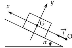
Les frottements sont négligés : la force modélisant l'action du plan incliné sur le solide est donc perpendiculaire au plan incliné.
