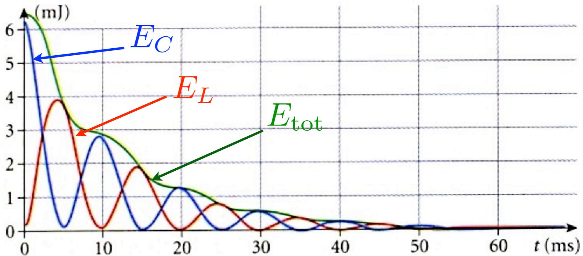
4) La décroissance de l'énergie totale s'explique par la dissipation de l'énergie dans la résistance, par effet Joule.
