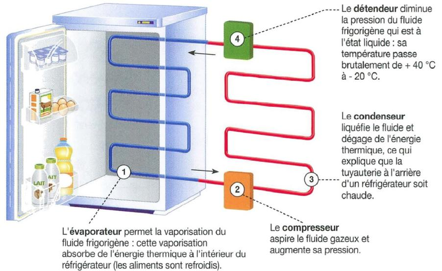
Un fluide « frigorigène » circule dans un circuit étanche. Il subit de manière cyclique une vaporisation (passage de l'état liquide à l'état gazeux) puis une liquéfaction (passage de l'état gazeux à l'état liquide). Ces changements d'état impliquent des échanges thermiques permettant de refroidir l'intérieur du réfrigérateur.
