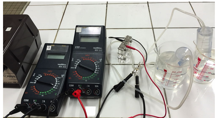
FIG. 3 – Dispositif expérimental de la pile à combustible réversible.
