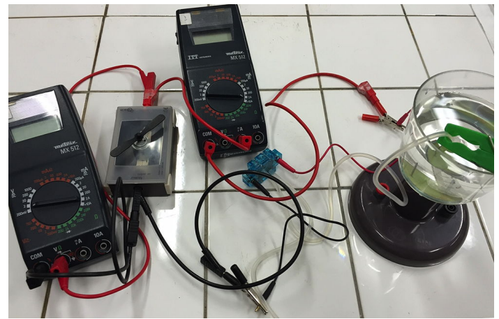
FIG. 6 – Dispositif expérimental de de décharge (pour la PAC non réversible).
