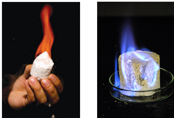
FIG. 8 – Combustion d'hydrates de gaz dans le dioxygène de l'air.
