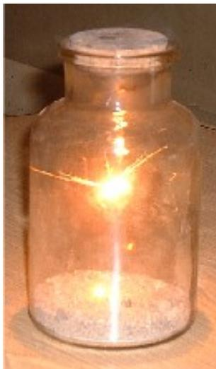
FIG. 7 – Combustion du fer dans le dioxygène.
