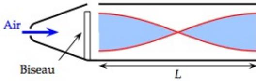
Dans le modèle proposé, il y a toujours un ventre de vibration à chaque extrémité du tube. Le schéma ci-dessus représente l'élongation maximale du déplacement des tranches d'air le long de l'axe du tube pour un mode fondamental.
