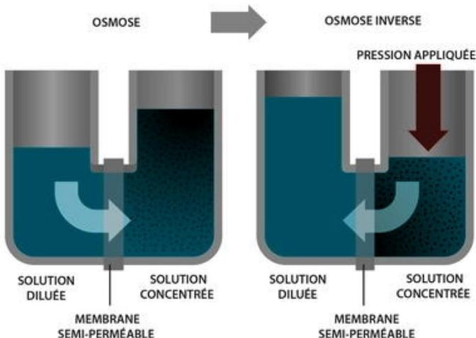
Dans l'osmose inverse, on empêche le transfert d'eau de se réaliser normalement en exerçant une pression sur la solution la plus concentrée. Ainsi l'eau passe vers la solution la moins concentrée, tandis que les espèces dissoutes restent dans le compartiment.
