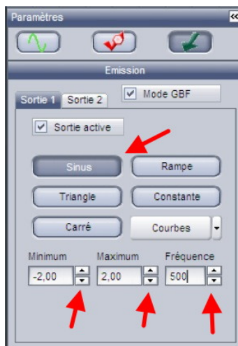
FIG. 14 – Forme et amplitudes du signal de sortie.
