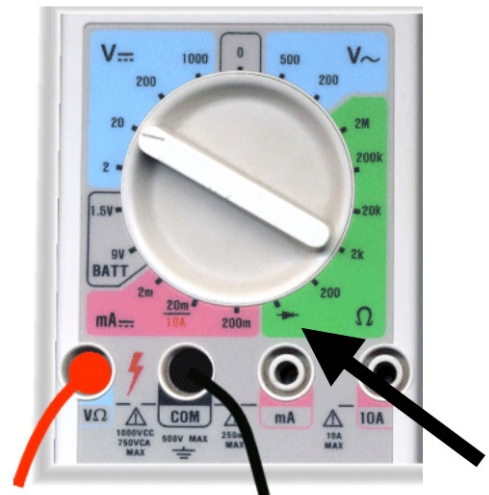
FIG. 8 – Test d'une diode. Bien noter le branchement des fils et la position du commutateur.
