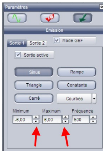
FIG. 21 – Réglage de l'amplitude du GBF
