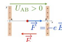
où  $U_{AB} = V(B) - V(A)$  est la « différence de potentiel » ou tension entre les deux plaques A et B. L'électron est attiré par la plaque B chargée  $\oplus$  : accord.
