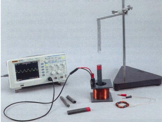
À l'aide d'un chronomètre, mesurer tout d'abord précisément la période d'oscillation de l'aimant.
