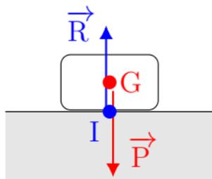
Un corps en mouvement rectiligne uniforme est lui aussi, d'après le principe d'inertie, soumis à des forces qui
