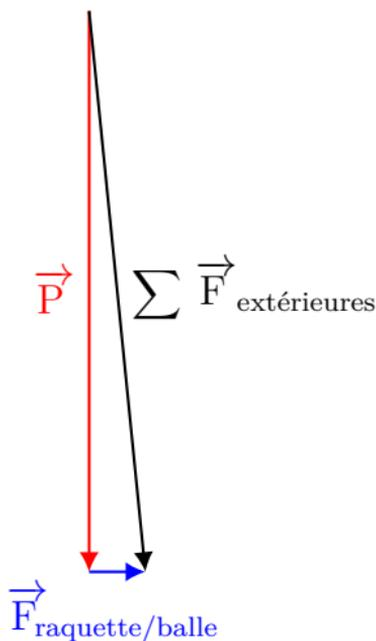
La force résultante (ou simplement « la résultante ») est construite en reliant l'origine de la première force avec l'extrémité de la dernière. On la note  $\sum \vec{F}_{\text{extérieures}}$ , « somme des forces extérieures » appliquées au système (ici, la balle de tennis).
