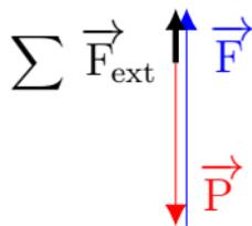
Le schéma étant à l'échelle, on peut mesurer la longueur de la résultante : 0,5 cm, et en déduire sa valeur en newton en utilisant l'échelle :
