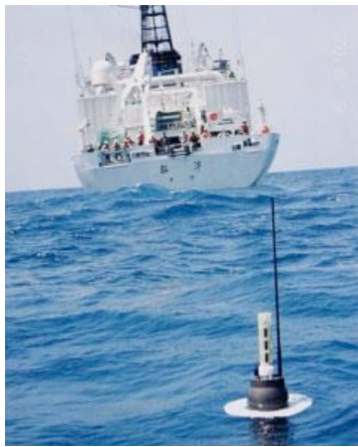
Une bouée de mesure du système ARGO.
