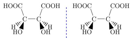
La molécule est identique à son image dans un miroir : les deux molécules sont superposables, la molécule n'est pas chirale, en raison de l'existence d'une symétrie dans la molécule. Cette molécule est une forme *méso*.
