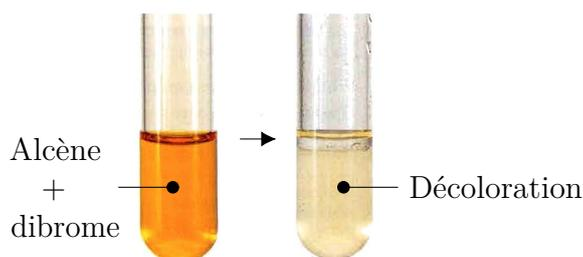
FIG. 1 – Test caractéristique d'un alcène.
