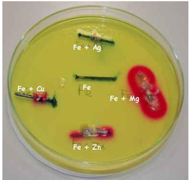
FIG. 3 – Mise en évidence des protections dans un gel d'agar-agar.
