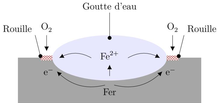
FIG. 2 – Corrosion du fer.
