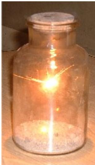
FIG. 5 – Combustion du fer dans le dioxygène.
