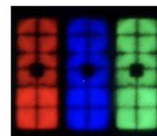
FIG. 5 – Forme des filtres de couleur d'un pixel de l'écran d'un téléviseur LCD récent (Panasonic).
