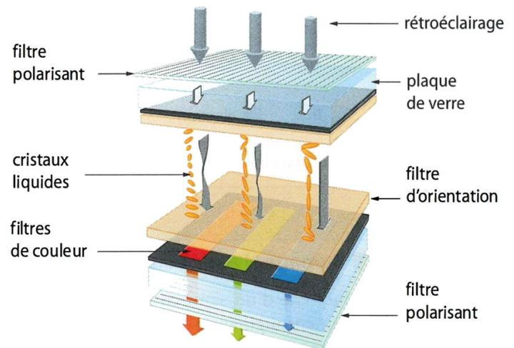
FIG. 4 – Constitution d'un pixel d'un écran LCD.
