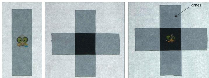
FIG. 9 – Observation d'un petit objet en cristal liquide.
