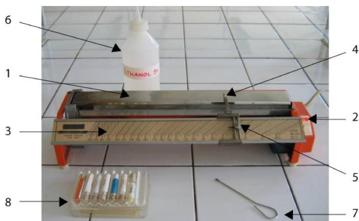
FIG. 10 – Banc Köfler et ses accessoires.
