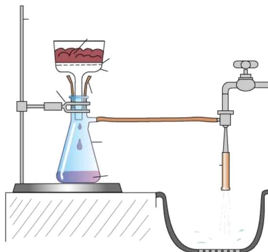
FIG. 8 – Montage de filtration sous vide.
