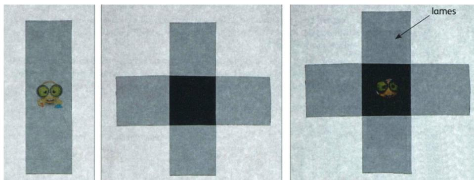
FIG. 9 – Observation d'un petit objet en cristal liquide.
