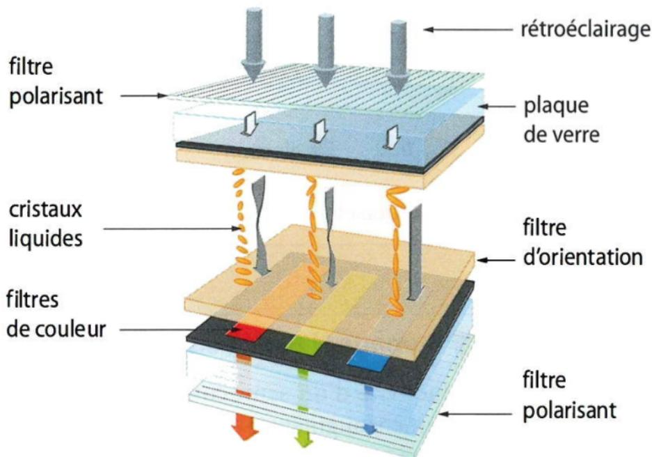
FIG. 4 – Constitution d'un pixel d'un écran LCD.
