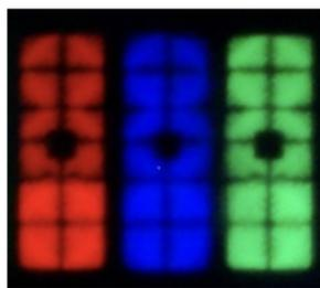
FIG. 5 – Forme des filtres de couleur d'un pixel de l'écran d'un téléviseur LCD récente (Panasonic).
