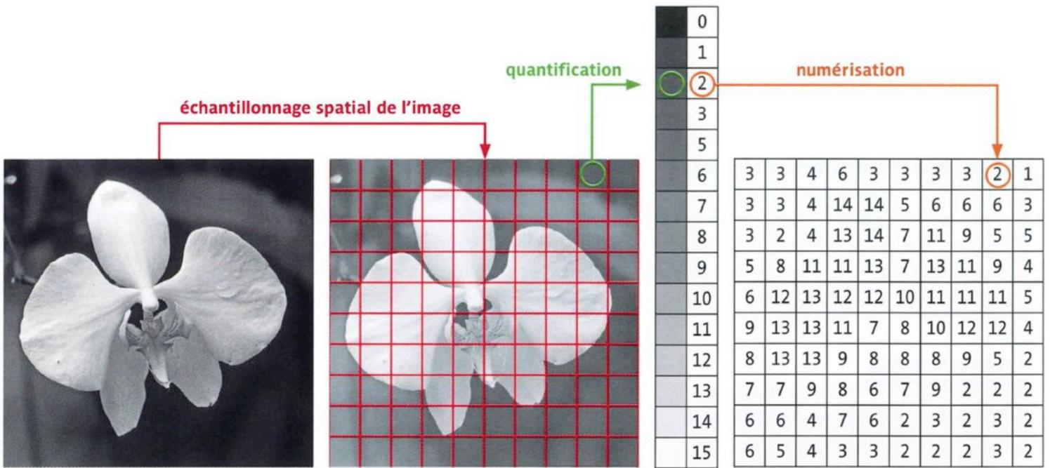
L'intensité lumineuse, grandeur analogique, est convertie par la cellule en un signal analogique sous forme de tension électrique. Elle est ensuite quantifiée, puis numérisée. À chaque valeur d'intensité lumineuse correspond un niveau de gris codé numériquement.
