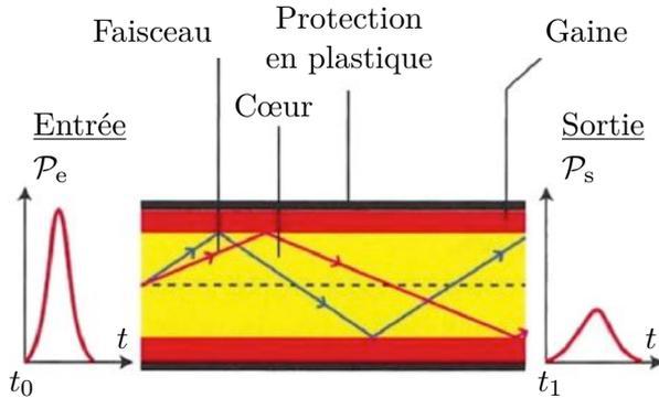
FIG. 3 – Fibre à saut d'indice
