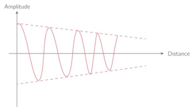
FIG. 10 – Atténuation du signal.
