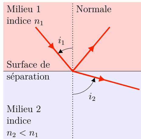
Dans ce dernier cas, à partir d'un certain angle d'incidence  $i_1$  supérieur à un angle limite, il y a **réflexion totale**, c'est-à-dire aucun rayon réfracté :
