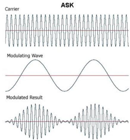
FIG. 6 – Modulation d'amplitude.
