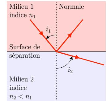
Dans ce dernier cas, à partir d'un certain angle d'incidence  $i_1$  supérieur à un angle limite, il y a **réflexion totale**, c'est-à-dire aucun rayon réfracté :
