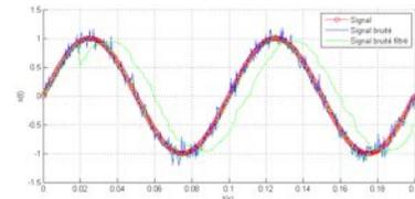
FIG. 9 – Bruit blanc sur un signal sinusoïdal.
