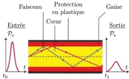
FIG. 3 – Fibre à saut d'indice
