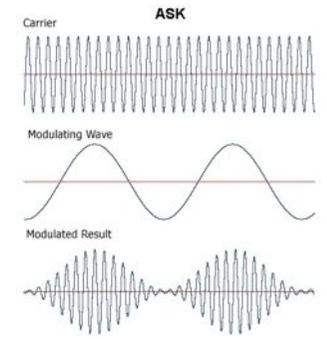
FIG. 6 – Modulation d'amplitude.
