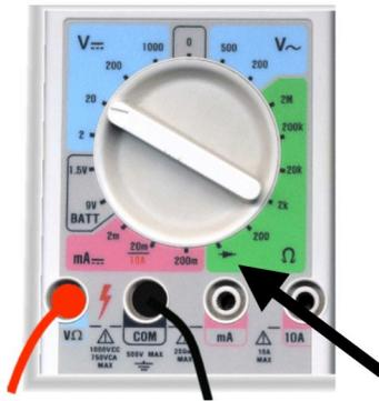
FIG. 26 – Test d'une diode. Bien noter le branchement des fils et la position du commutateur.
