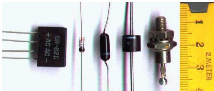
FIG. 22 – Différentes formes de diodes.
