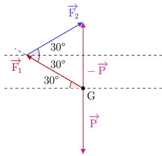
Le vecteur poids est selon le côté opposé à l'angle, noté  $\alpha = 30^\circ$ , dans les deux triangles rectangles. Les tensions des fils sont selon les hypoténuses des triangles rectangles. Il faut utiliser un sinus :
