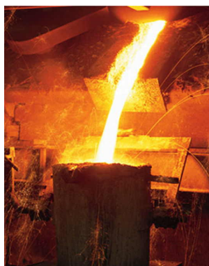
Coulée d'un haut-fourneau.
