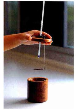
Le calorimètre est thermique isolé (comme une bouteille thermos) : on considère qu'il n'y a aucun transfert d'énergie entre lui et le milieu extérieur.
