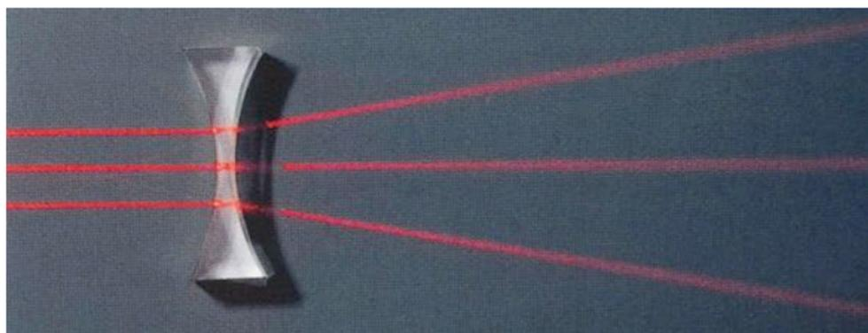
Le faisceau émergent de la **lentille à bords épais** *diverge* .
