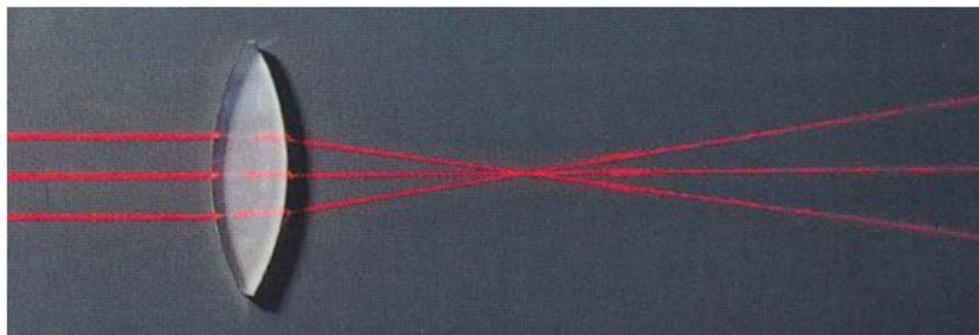
Le faisceau émergent de la **lentille à bords minces** *converge* en un point.
