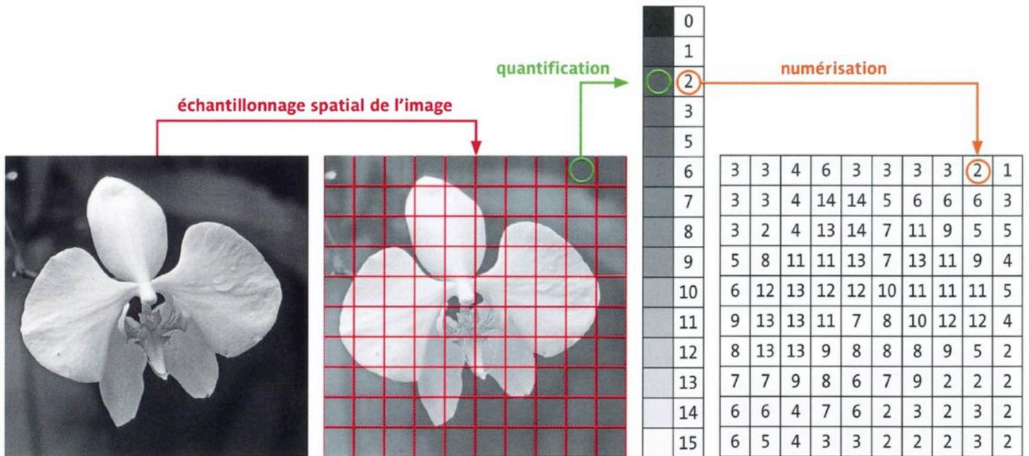
L'intensité lumineuse, grandeur analogique, est convertie par la cellule en un signal analogique sous forme de tension électrique. Elle est ensuite quantifiée, puis numérisée. À chaque valeur d'intensité lumineuse cor-
