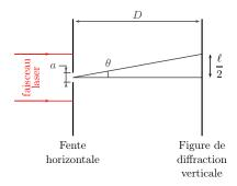
Ouverture du faisceau diffracté Le demi-diamètre apparent — ou demi-ouverture angulaire  $\theta$  d'un faisceau de lumière de longueur d'onde  $\lambda$ , diffracté par une fente ou un fil de dimension a, est donnée par la relation :
