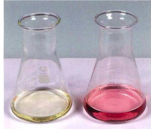
FIG. 17 – Couleurs du mélange avant et après l'équivalence.
