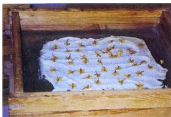
FIG. 1 – Un chassis d'enfleurage. La graisse est déposée sur un support en verre.
