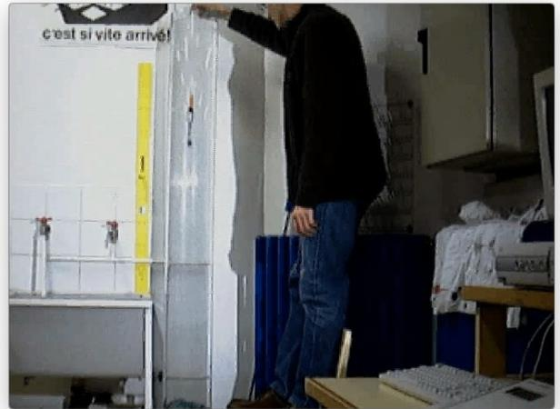
→ `m24.5g_meau18.9g_10is.avi` pour la chute dans l'éprouvette « géante » d'un solide de masse  $m = 24,5$  g, la masse de l'eau déplacée (pour la poussée d'Archimède) étant  $m_{\text{eau}} = 18,9$  g, la vidéo étant tournée à dix images par seconde.
